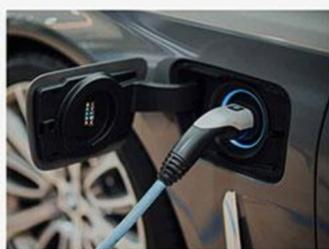
Pool di 4 vetture elettriche a servizio della Cittadella. 2 sistemi di ricarica FAST (uno di potenza 24 kW DC con connettori multi-standard + 22 kW AC tipo 2 e uno da 50 kW max in DC + 22 kW AC) e 1 sistema di ricarica QUICK (2x22 kW AC e connettore Tipo 2).
