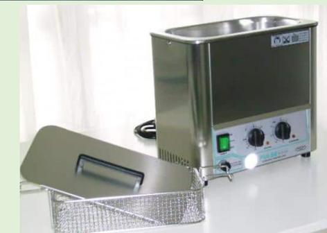
Bagno ad ultrasuoni per il lavaggio della strumentazione
